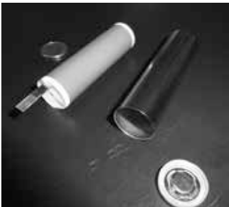
Basis des Energiespeichersystems von Tesla sind Lithium-Ionen-Rundzellen. Dabei handelt es sich um Zylinder mit 18 mm Durchmesser und 65 mm Länge. (wikipedia)
