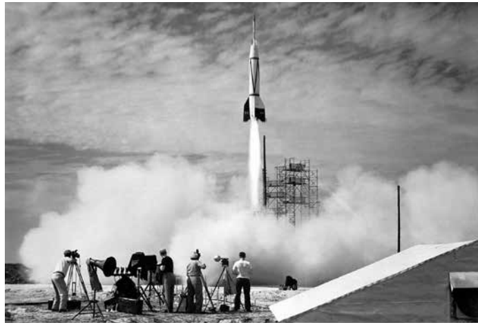
1950 fanden auf Cape Canaveral die ersten Raketenstarts statt. Getestet wurde hier die Bumper-Rakete, eine erbeutete deutsche A4-Rakete mit einer Corporal-Oberstufe. (Foto Nasa, gemeinfrei)
