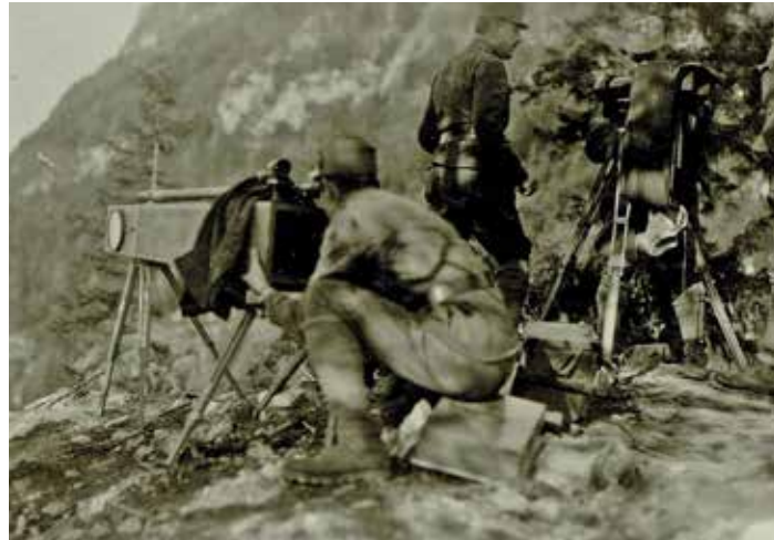
Kriegsfotografie, Hinterland der Isonzofront (1916), Erprobung der 3m Kamera. Aufnahmen mit der Fernkamera (80 cm Brennweite) Magnar und dem 18-fachen Fernrohr. Fotograf: 10. Armeekommando. (Foto: Österreichische Nationalbibliothek / K.u.k. Kriegspressequartier, Lichtbildstelle – Wien / Public Domain)
