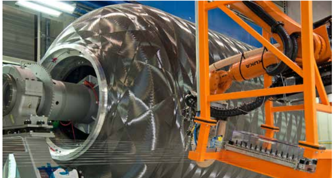
Das Boostergehäuse aus Carbonfasern für die Ariane 6 wurde beim DLR Stuttgart und Augsburg in Kooperation mit MT Aerospace entwickelt und gefertigt. Foto: 2015-07-01 (Quelle: DLR (CC-BY 3.0))
